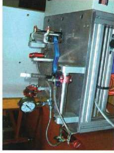
Machine à tester les 100 000 cycles de freinage pour l'homologation aéronautique.
