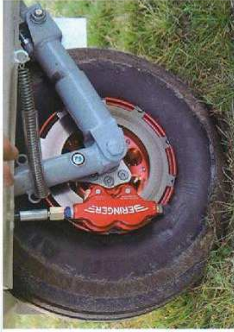
On voit bien la filiation entre cette roue/frein d'avion et le nouveau "Inboard Brake System" de Beringer.
