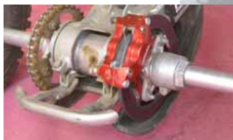
disque + étrier + platine
