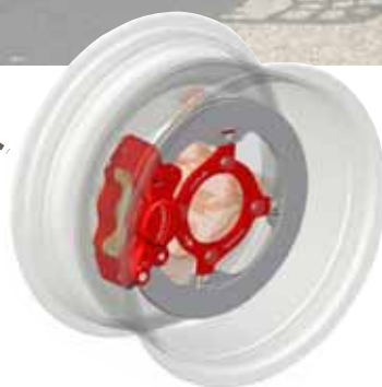
ensemble disque-étrier dans la roue avant (roue de 10")
