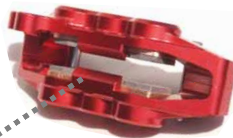
Chanfrein de guidage du disque
